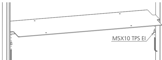
È consigliabile effettuare un preforo  $\varnothing 3$  per facilitare il fissaggio con viti 4.2x32 .
