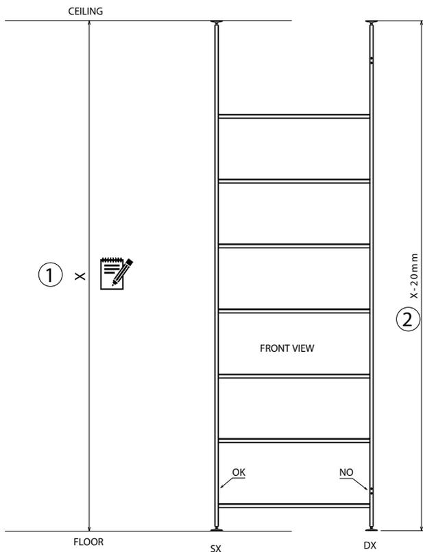
1: prendere nota dell'altezza effettiva tra pavimento e soffitto. Misurare la distanza che intercorre tra piedino superiore e inferiore. Regolare i piedini superiori e inferiori in maniera tale che la distanza totale sia 20mm inferiore alla distanza nominale tra soffitto e pavimento. In presenza del perno di sicurezza bisogna considerare la distanza tra l'estremità del perno e il piedino inferiore.
