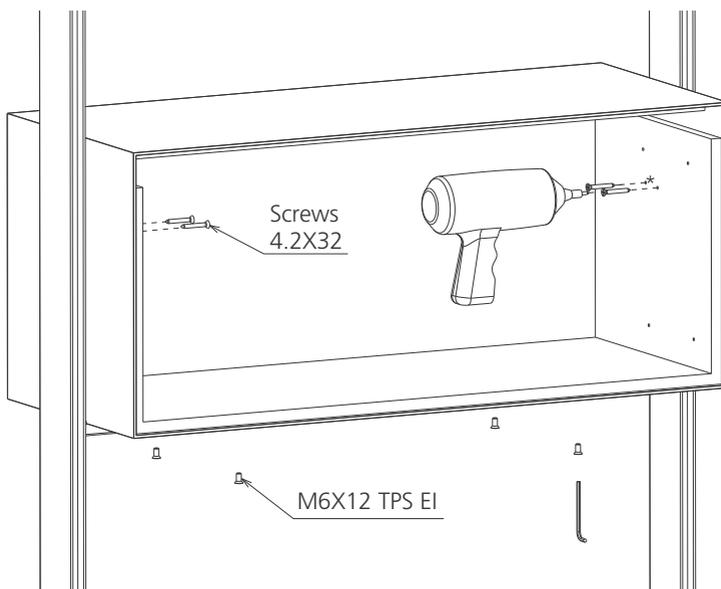
5. ISTRUZIONE DI MONTAGGIO RIPIANO INCLINATO
